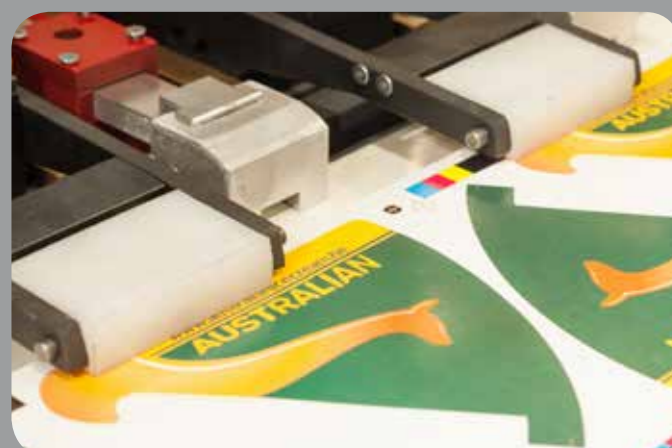
5 PINZA E RISMATORE PNEUMATICI PROGRAMMABILI RETRATTILI CLAMP AND REAM-FORMER (PNEUMATIC-PROGRAMMABLE-RETRACTILE)
