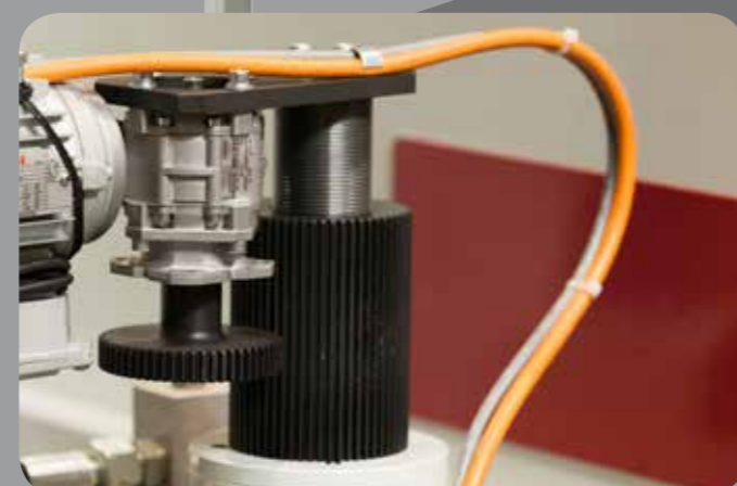
7 GRUPPO PROGRAMMABILE REGISTRO PROFONDITÀ DI TAGLIO UTENSILE PROGRAMMABLE GROUP FOR CUTTING DEPTH'S SETTING
